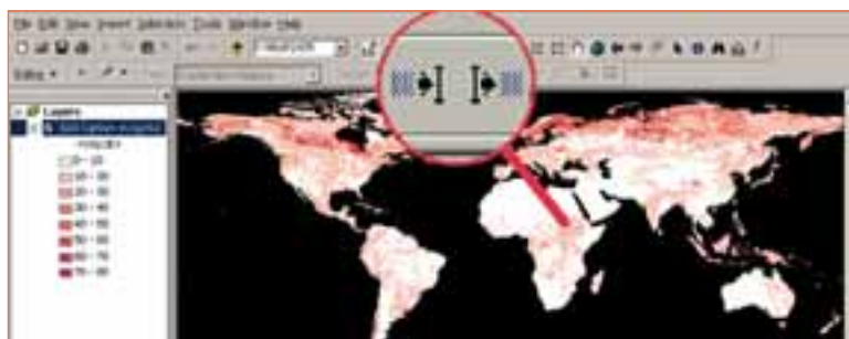
Die nach der Installation neu hinzugefügten Buttons (Grid to Idrisi; Idrisi to Grid) im Schaltflächenmenü von ArcMap
